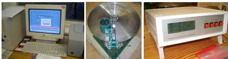
12.att. Tribometriskais stends un tā sastāvdaļu kopskats Fig.12. Tribometric test bench and it's assembly
