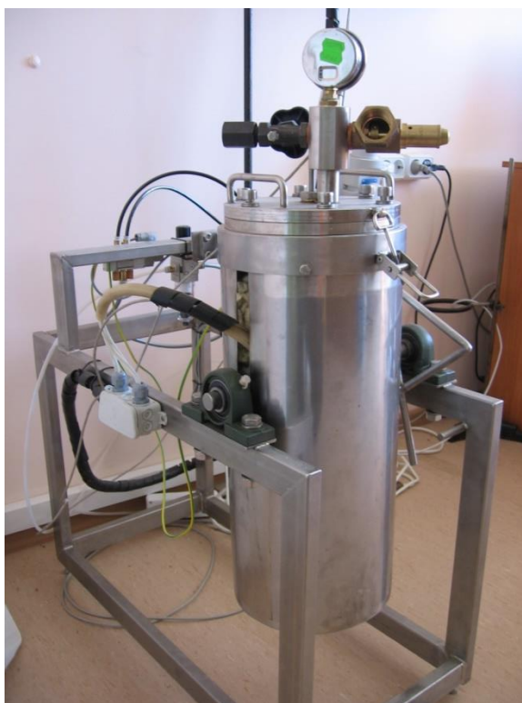
2.2.att. Reaktors koksnes šķiedru ķīmiskai izdalīšanai.
