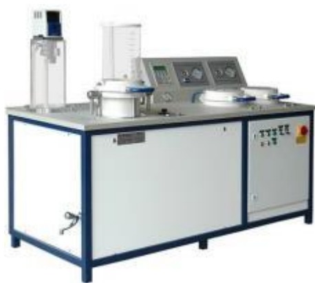
2.9.att. Iekārta Rapid-Köthen šķiedru plāno atlējumu iegūšanai:
