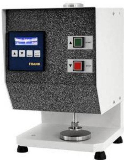
2.10.att. Mikrometrs šķiedru atlējumu biezuma noteikšanai.
