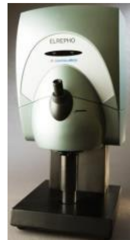
2.16.att. Spektrofotometrs atlējumu virsmas optisko īpašību noteikšanai.
