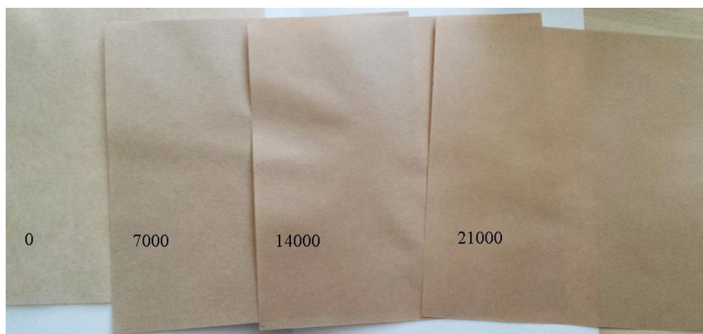
3.29.att. No koksnes ķīmiski izdalītu šķiedru atlējumi, gatavoti no šķiedrām pēc dažāda n_{PFI} mehāniskās apstrādes.
