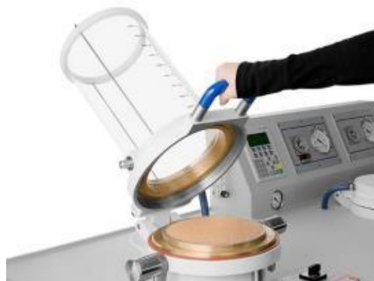
2.9.att. Iekārta Rapid-Köthen šķiedru plāno atlējumu iegūšanai:
