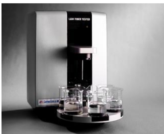
2.6.att. FiberTester iekārta šķiedru dimensiju noteikšanai.
