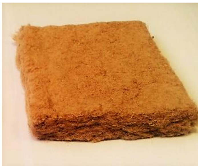
3.72.att. Koksnes šķiedru plātnes modelis, veidots no finiera ražošanas blakusproduktu (Bērza koksnes serdeņi) termomehāniskā procesā iegūtām šķiedrām.
