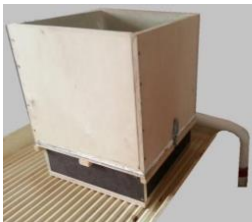
2.18.att. Iekārta koksnes šķiedru plātņu iegūšanai:
