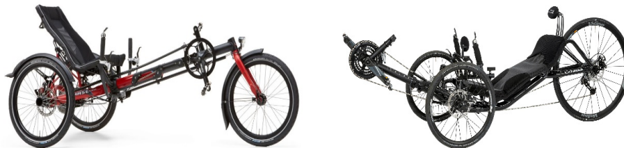
1. att. Trīsriteņu konstrukcijas veidi
