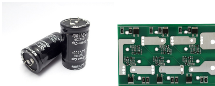
2. att. Izmantotie superkondensatori un uzlādēšanas līdzsvarošanas shēmas plate pirms modifikācijas
