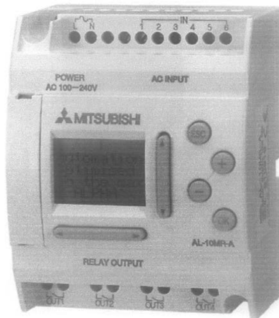
Figure 3. ALPHA logical controller, model AL-10MR-D (Automatyka Napędy..., 2012).
