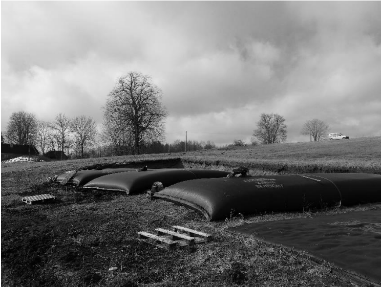
1. att. Geotube maisu izvietojums Bižas ezera krastā: trešajā geotube maisā no kreisās puses ir ievietoti mitruma sensori.
