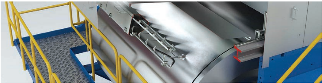
1.67. att. Dieffenbacher izstrādātā iekārta piedevas izsmidzināšanai uz vienstāvu nepārtrauktas darbības preses lentēm.
