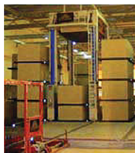
1.80. att. Automatizētas rulliņu transportieru sistēmas plātņu uzglabāšanai starpnoliktavā (Thoemen u.c., 2010).
