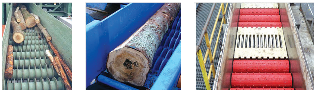
2.8. att. Diskveida, veltņveida apaļkoku garentransportieri mizas un piemaisījumu atdalīšanai.
