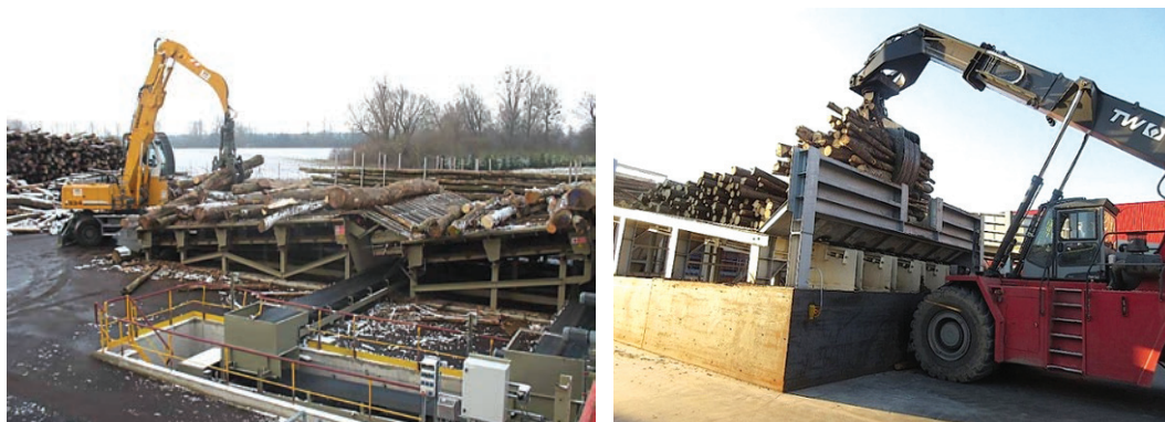
2.4. att. Apaļo sortimentu padošana ar autoiekrāvēju OSB tehnoloģiskajā plūsmā.
