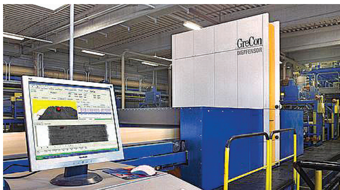
1.52. att. Skaidu „paklāja” bezkontakta mērīšanas iekārta.
