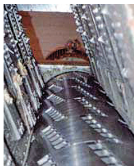
1.12. att. Vertikālās padeves trumuļveida šķeldotājs (Thoemen u.c., 2010), griezējnazis un rotācijas galva:
