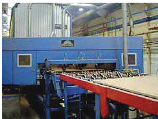
1.74. att. Plātņu sazāģēšanas garumā un platumā apzāģēšanas agregāti (Thoemen u.c., 2010).
