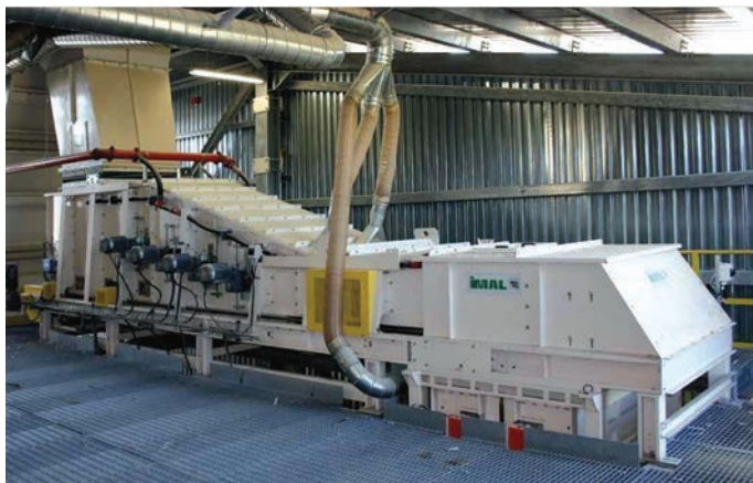
2.19. att. Skaidu svēršanas-dozēšanas agregāts padevei uz apsveķošanu.
