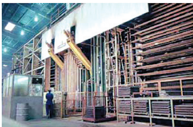
1.59. att. Daudzstāvu prese ar plātņu iekraušanas un izkraušanas etažerēm (Volinskis, 2007).
