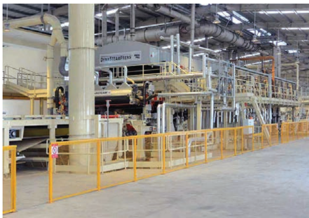
2.30. att. Nepārtrauktas darbības prese ar iebūvētu tvaika iesmidzināšanas sistēmu.
