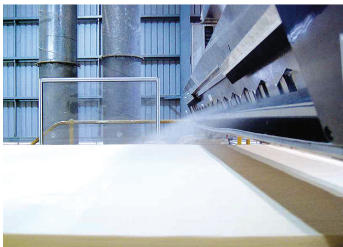
2.28. att. Izsmidzināšanas palīgapriekojums plātnes virsmas kvalitātes paaugstināšanai.
