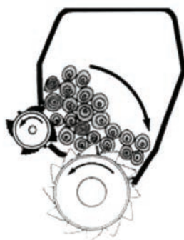
1.9. att. Apaļo kokmateriālu mizošanas principiālā darbības shēma (Volinskis, 2004).
