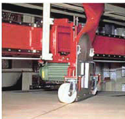
1.74. att. Plātņu sazāģēšanas garumā un platumā apzāģēšanas agregāti (Thoemen u.c., 2010).
