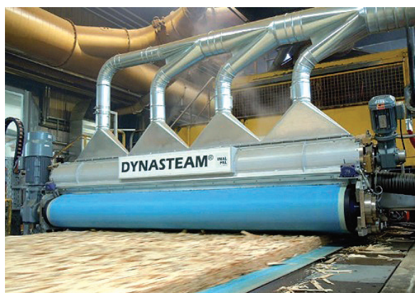
2.29. att. Tvaika iesmidzināšanas palīgapriekojums.
