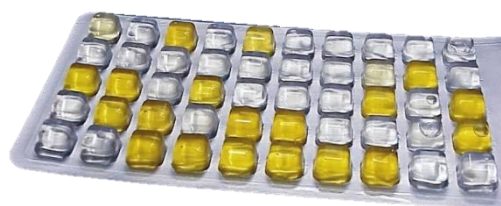
35. att. Quanti-Tray plate, dzeltenā krāsa norāda uz kopējo koliformu klātbūtni
