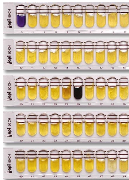
37. att. API 50 CH testa strips ar mikroorganismu veidotām bioķīmiskām reakcijām
