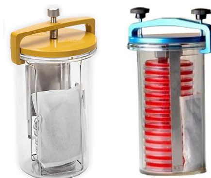
8. att. GasPak anaerobā sistēma: anaerostati ar GasPak maisiņu un Petri platēm
