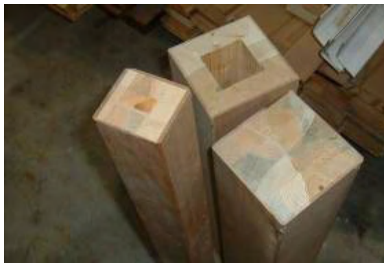
2. att. Lapu koku koksnes izmantošana nesošu konstrukciju elementos. Fig. 2. Hardwood used for structural timber elements.
