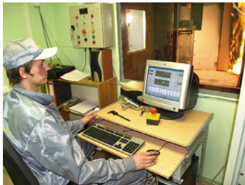
4. att. Materiālu testēšana SBI iekārtā. Fig. 4. Testing of materials in SBI equipment.
