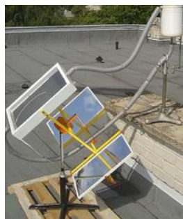
2.4. att. Plakana saules enerģijas kolektoriekārta LV 13371 B aprobācija Fig. 2.4. Solar energy collector (patent LV 13371 B)
