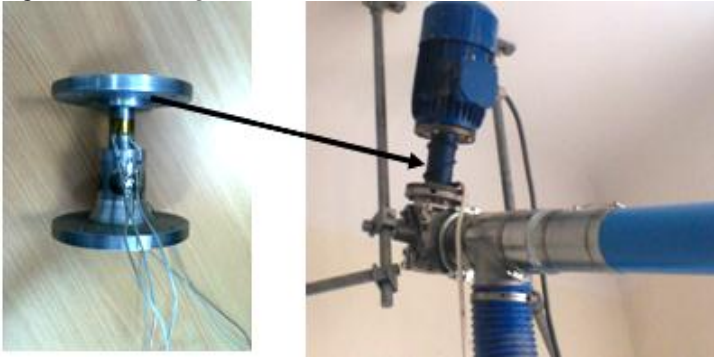
2.1. att. Ar dinamometrisko sensoru aprīkots transportiera piedziņas vārpstas starpgabals, transportiera piedziņas mezgls samontētā veidā
