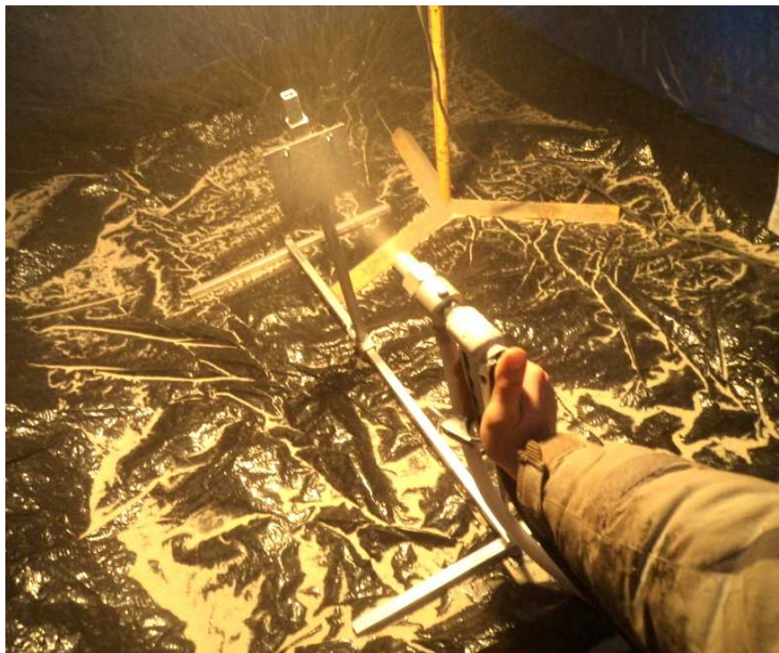
2. att. Parauga apsmidzināšana ar smilšu strūkļu
