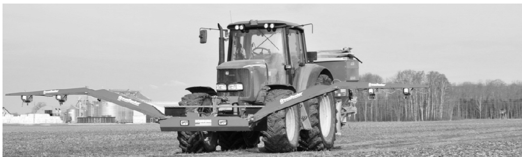
3. att. AO GreenSeeker optisko sensoru sistēma slāpekļa izkliedei.
