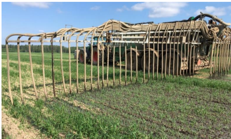
2. att. Šķidrmēslu izkliede ar nokarenajām caurulēm.
